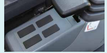
Plek voor extra schakelaars bij linkerconsole
