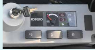
Lay-out rechterconsole en -cluster + led achtergrondverlichting
