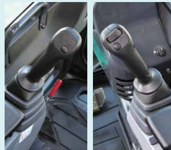
Hendel voor proportionele bediening voor leidingen van knipschaar en breker (optioneel)
