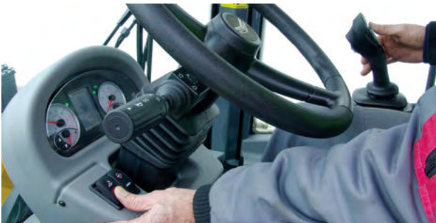
Einstellung der Ölmenge des dritten und vierten Kreises ueber das Display.
